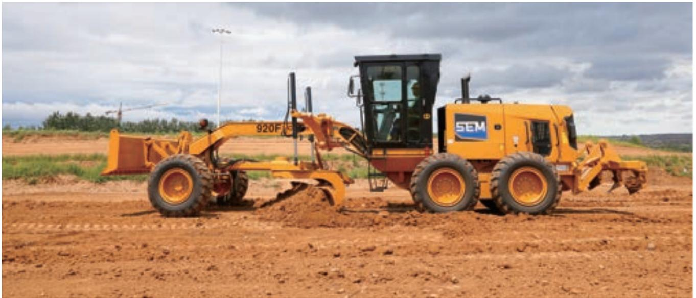
Стандартные области применения автогрейдера: черновое и окончательное профилирование, устройство откосов и канав, очистка канав, уборка снега. Автогрейдеры являются незаменимым оборудованием при строительстве дорог, обустройстве водоемов, расчистке и выравнивании сельскохозяйственных земель.
